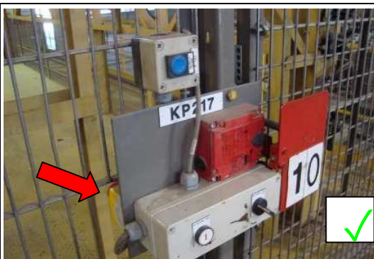
Toegangsbeveiliging deur naar productielijn; noodstop in zone
