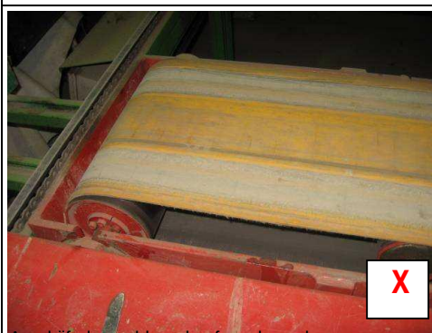
Aandrijfrol onvoldoende afgeschermd
