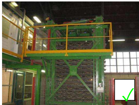
Bordes bij droge elevator is goed beveiligd
