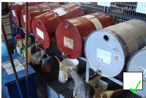
Opslag oliedrums op lekbakken en in afgesloten gebied.
