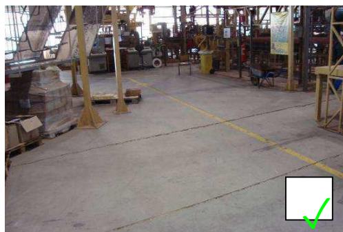
Gele doorgetrokken lijn voor aangeven looppad tussen productielijnen door
