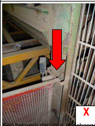
Een hekwerk dat vrij is opgehangen kan tijdens productie gemakkelijk verwijderd worden zonder dat de machine stopt
