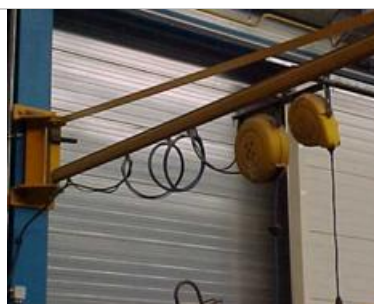
Zwenkarm om lucht en elektriciteit aan te hangen (geen snoeren op de vloer)
