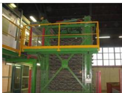
Bordes bij droge elevator is goed beveiligd
