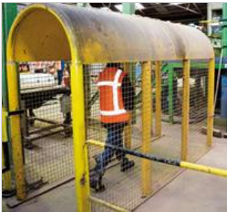
Afscherming looppad onder hijswerkzaamheden
