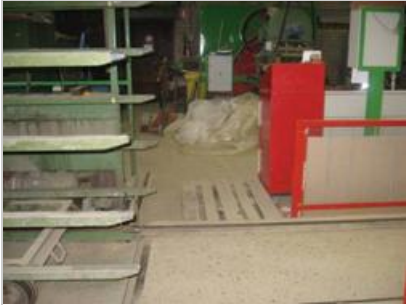
Gevaar van aangereden worden door bovenwagen van kleine traversewag
