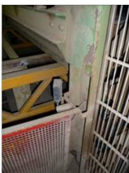
Rol opgaande zandband onvoldoende afgeschermd
