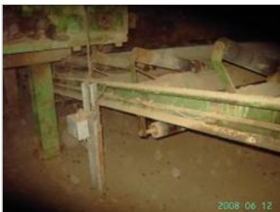
Rol opgaande zandband onvoldoende afgeschermd
