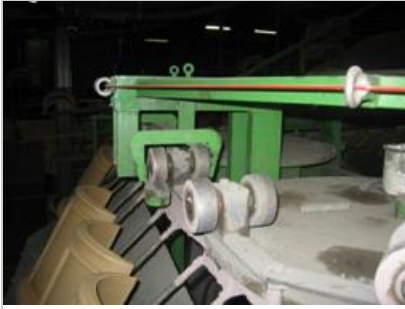
Beknellingsgevaar onder rollers carroussel.
