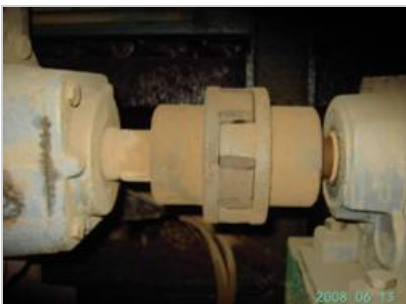
Afscherming bij draaiende as kleibeschikker ontbreekt
