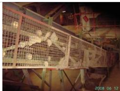
Opgaaande kleiband afgeschermd met vast hekwerk
